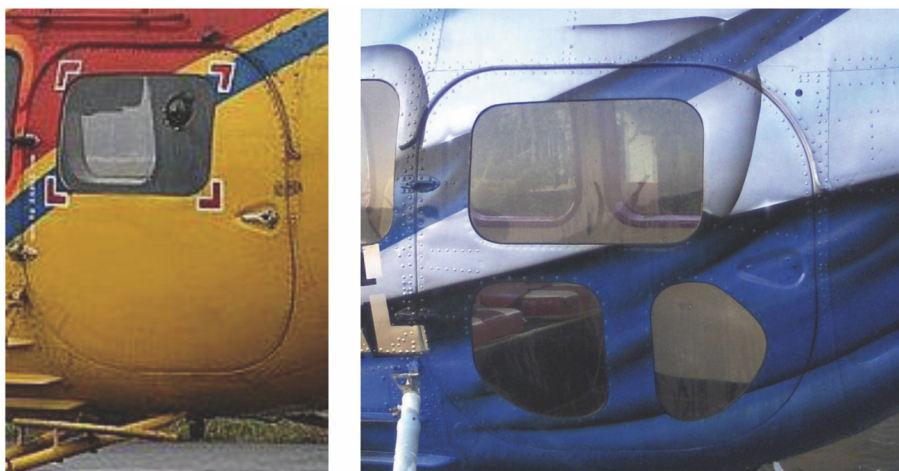
Rys. 6. Modernizacja drzwi kabiny ładunkowej: a) drzwi tradycyjnego Mi-2, b) poszerzone i dodatkowo przeszklone drzwi kabiny ładunkowej zmodernizowanego Mi-2 (Foto [2], 2010)
