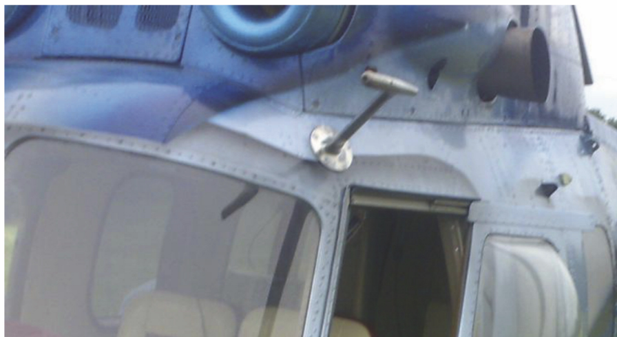
Rys. 3. Nowe miejsce zabudowania dajnika ciśnienia powietrza (Foto [2], 2010)
