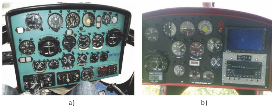
Rys. 4. Modernizacja tablicy przyrządów: a) wygląd tablicy tradycyjnego Mi-2, b) tablica przyrządów zmodernizowanego Mi-2 (Foto [2], 2010)
