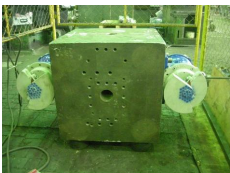
Rys. 5. Pomiar przy wymuszeniu drgań za pomocą silników rotodynamicznych typu OVE 112.M 630 w układzie podwójnym (zsynchronizowanym) przy zasilaniu przemiennikiem częstotliwości
