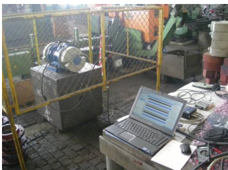
Rys. 4. Pomiar przy wymuszeniu drgań za pomocą silników rotodynamicznych typu OVE 112.M 630 w układzie pojedynczym
