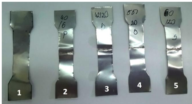
Rys. 5. Próbki przed statyczną próbą rozciągania: 1 – próbka wzorcowa, 2-5 – próbki o różnych parametrach spawania X/Y, gdzie X – intensywność spawania (% maksymalnej mocy); Y – czas impulsu (ms); wybór pulsacji: P – proszki, R – druty i taśmy
