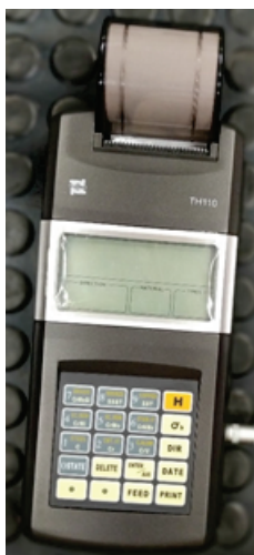
Rys. 3. Twardościomierz TH – 110 (Leeba) wykorzystany podczas badań twardości Fig. 3. TH –110 hardness tester (Leeba) used during hardness tests
