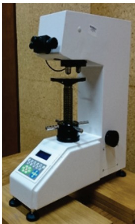
Rys. 2. Twardościomierz HV 10 wykorzystany podczas badań Fig. 2. HV 10 hardness tester used during tests
