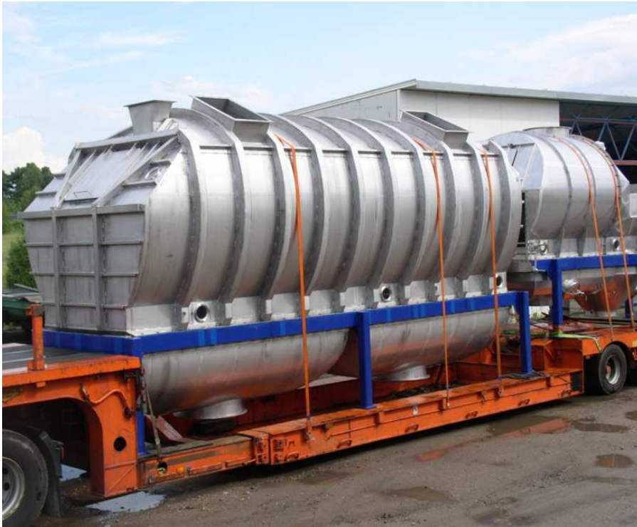
Rys. 1. Zestaw suszarki i chłodziarki cukru o wydajności 400 ton na dobę zainstalowany w 2003 roku w Cukrowni Liepaja na Łotwie
