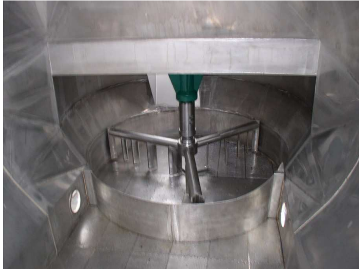
Rys. 2. Wnętrze komory górnej suszarki cukru o wydajności 400 ton na dobę Fig. 2. Inside of the upper chamber of sugar dryer of capacity 400 tons per day
