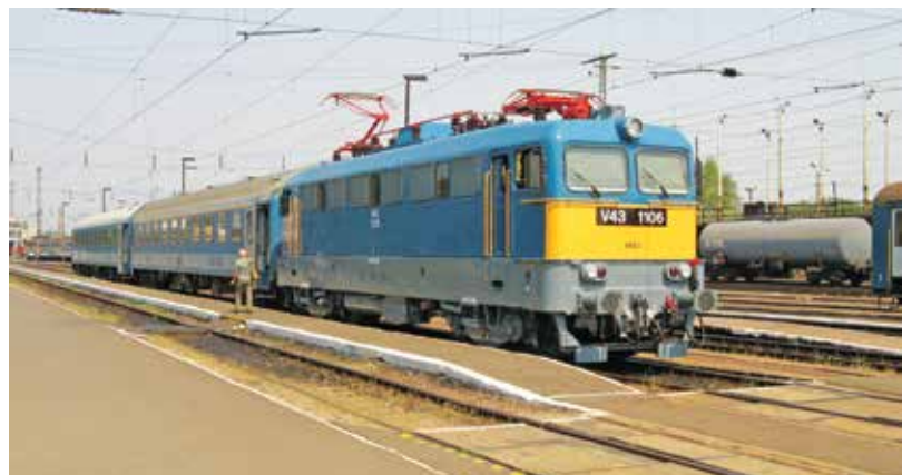
V43-1106 (producent Ganz-MÁVAG, 25 kV 50 Hz) z poc. IC do Budapesztu na stacji Záhony, Węgry (21.07.2007 r.)
