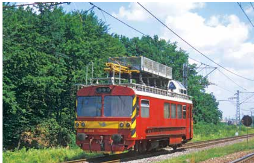
Wagon silnikowy (1 520 mm) serii 891-801 do napraw sieci trakcyjnej na ŠRT, Słowacja (29.07.2007 r.). Fot. P. Štefek
