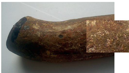
Rys. 1. Zdjęcie makroskopowe wycinka węzownicy przegrzewacza pary pierwotnej ze stali 16Mo3
