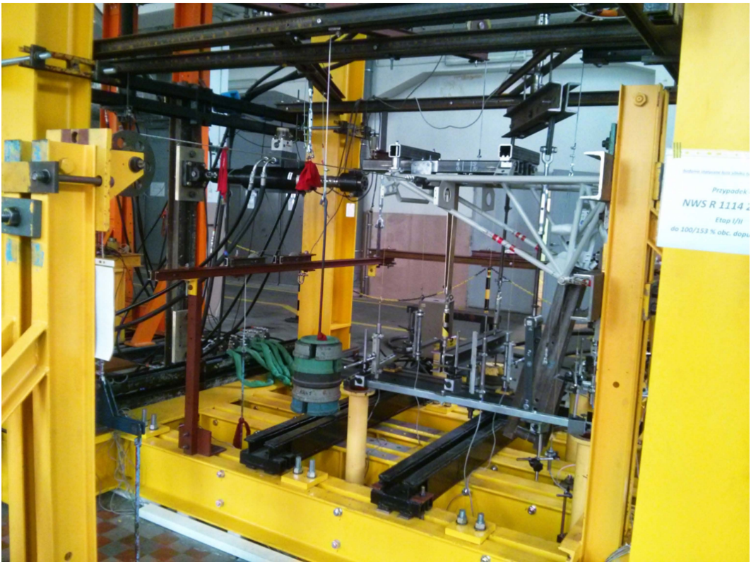
Rys. 19. Łoże silnika samolotu I-31T w trakcie prób statycznych [Cichocka, 2014]
