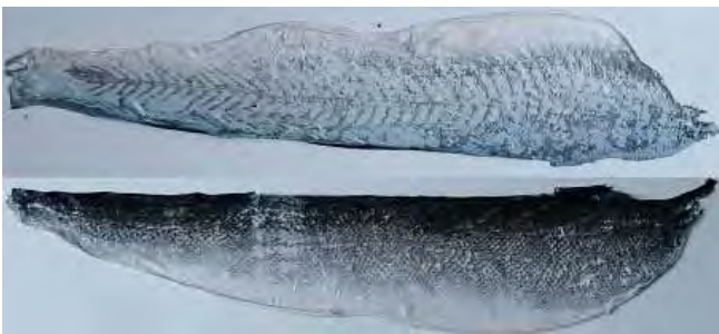
Rys. 6. Skóra oczyszczona obustronnie w modelu urządzenia. Fig. 6. Salmon skin on both sides cleaned in tests.
