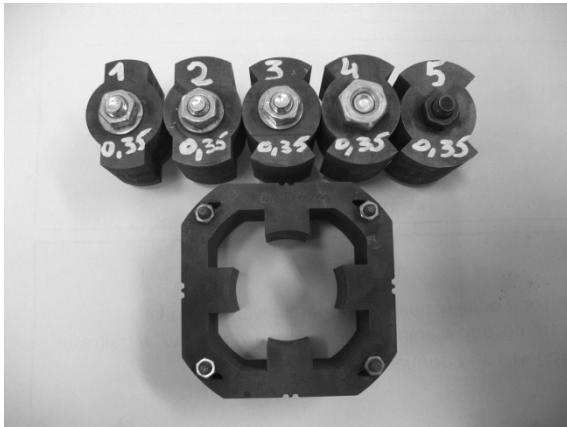
Rys.9. Widok pakietu stojana z różnymi wersjami wirnikami
