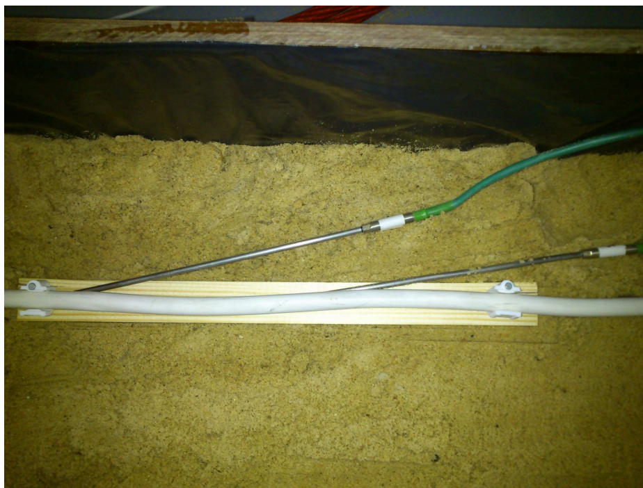
Rys. 1. Trasa kablowa pomiarowa, [opr. wł.]
