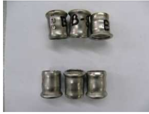
Rys. 4. Widok próbek ze stali nierdzewnej 0H17N12M2 niekorodowanych i korodowanych w 5% roztworze kwasu siarkowego.
