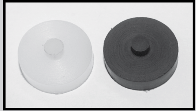
RYS. 3. Widok próbki pokrytej i niepokrytej warstwami węglowymi.
