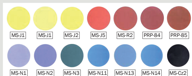
Fot. 2. Zeskanowane obrazy powierzchni farb naniesionych na płytki ceramiczne i wypalonych, 875°C w czasie 55 minut
