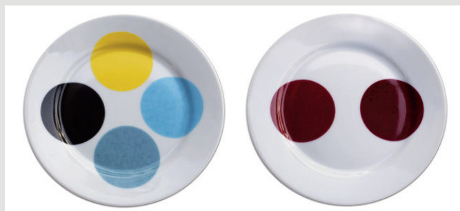
Fot. 3. Fotografie badanych farb naniesionych na porcelanę i wypalonych w temperaturze 875°C/360 minut/15 minut
