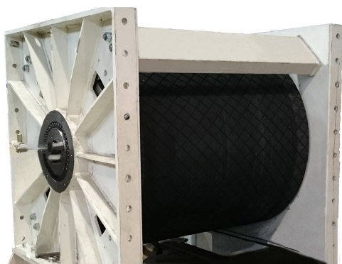
Rys. 3. Prototypowy napęd o mocy 250 kW zabudowany w korpusie
