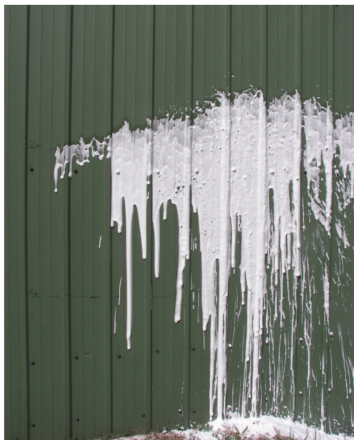
Ryc. 11. Piana wytworzona ze środka P33o temperaturze 20°C w 7 minut po nałożeniu
