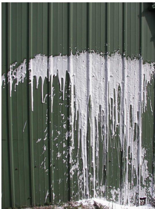
Ryc. 10. Piana wytworzona ze środka M13o temperaturze 20°C 7 minut po nałożeniu
