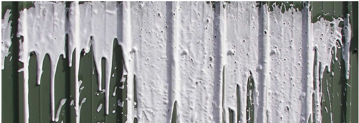
Ryc. 9. Piana wytworzona ze środka P33 o temperaturze 20°C zbudowana jest z baniek o niejednorodnej wielkości; występują komórki bardzo drobne oraz komórki o znacznie większym rozmiarze.
