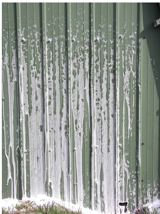
Ryc. 12. Piana wytworzona ze środka P33 o temperaturze 2°C w 7 minut po nałożeniu
