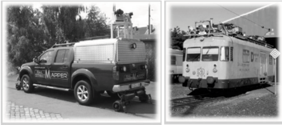
Rys. 2. Przykłady jednostek Mobilnego Skanowania Laserowego montowanych na pojazdach [24]
