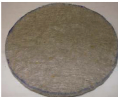
Fot. 11. Geowłóknina typu B, Polyfelt TS 80 po przeprowadzonym badaniu
