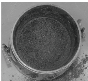
Fot. 7. Wynik badania niesortu granitowego \phi = 0 \div 20 \text{ mm} z izolacją antywibracyjną po usunięciu warstwy niesortu
