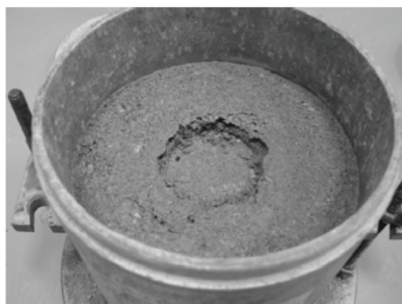
Fot. 12. Wynik badania niesortu granitowego \phi = 0 \div 20 mm z geowłókniną typu B
