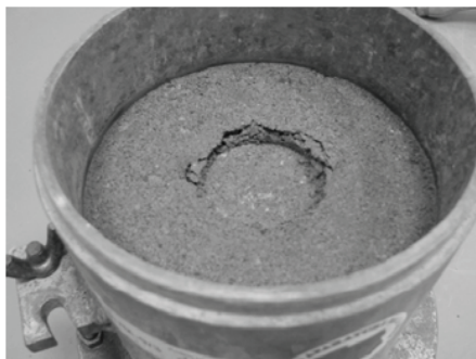
Fot. 9. Wynik badania niesortu granitowego \phi = 0 \div 20 \text{ mm} z geowłókniną typu A Polyfelt TS 30
