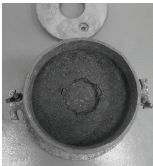
Fot. 5. Wynik badania niesortu granitowego \phi = 0 \div 20 mm bez materiału geosyntetycznego
