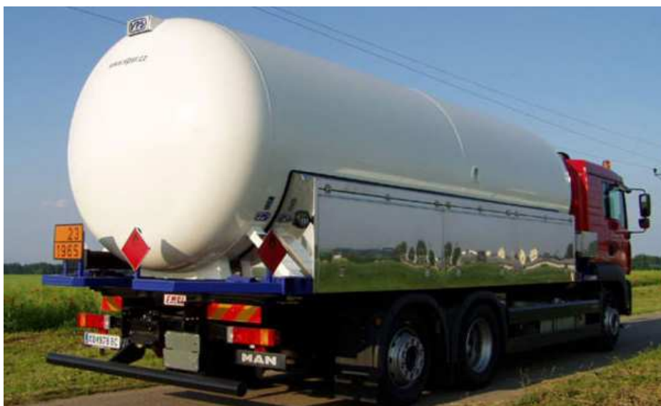
Rys. 4. Cysterna odejmowalna do transportu paliwa LPG
