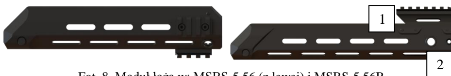
Fot. 8. Moduł łoża w: MSBS-5,56 (z lewej) i MSBS-5,56R (z prawej); w MSBS-5,56R zastosowano nakładkę łoża (1) oraz wykonano otwory pod mocowanie zaślepki (2) (rys. FB Radom)
