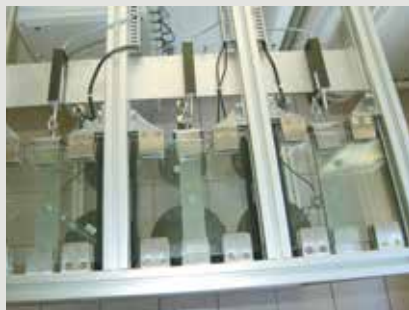
Fot. 4. Próbkki zamontowane w urządzeniu do badania pełzania
