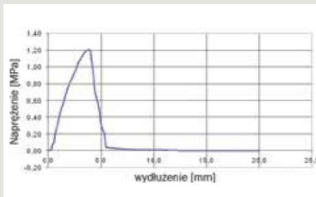
Rys. 1. Przebieg próby rozciągania próbki wykonanej na bazie szczeliwa S, poddanej działaniu promieniowania UV
