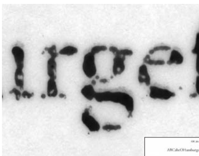
Rys. 9. Obraz pisma 3 pt grawerowanego Xtreme 230 R6 120 outlining 10 (a) i metodą tradycyjną (b), w powiększeniu na formie i odbitce oraz w skali 1:1 na odbitce
