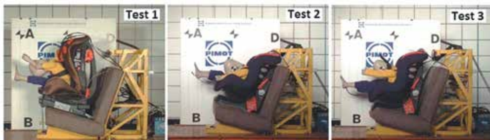
Rys.8. Maksymalne przemieszczenia manekina podczas testów (kadry z filmu). Test 1 –Fotelik 1. Test 2 i 3 – Fotelik 2
