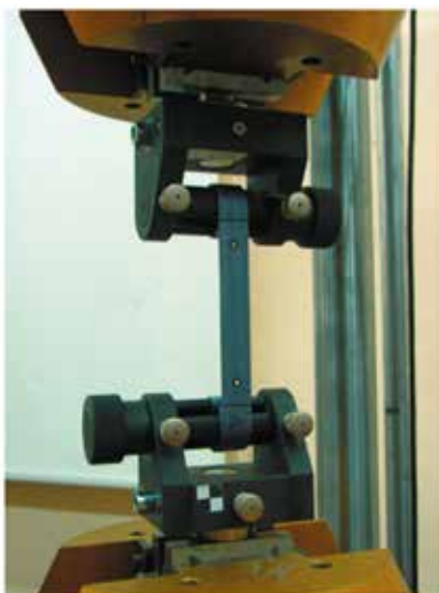
Rys. 4. Sposób mocowania pasów na stanowisku pomiarowym maszyny wytrzymałościowej Instron 8802
