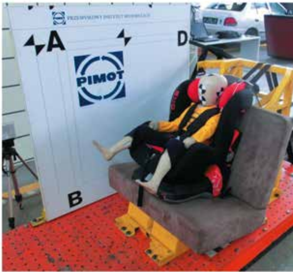
Rys. 7. Ogólny widok manekina dziecka posadowionego w foteliku bezpieczeństwa przymocowanym do kanapy samochodowej, połączonej sztywno z wózkiem pomiarowym
