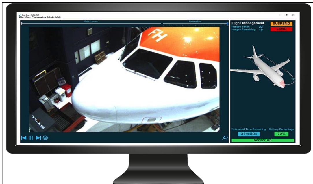
Rys. 6 System kontroli uszkodzeń statków powietrznych na bazie dronów - „Rapid”
