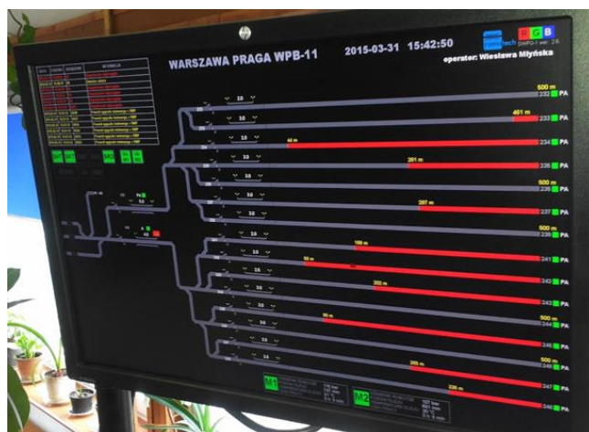
Rys. 5. Wizualizacja wolnej długości torów kierunkowych [fot. J. Tyszkowski]
