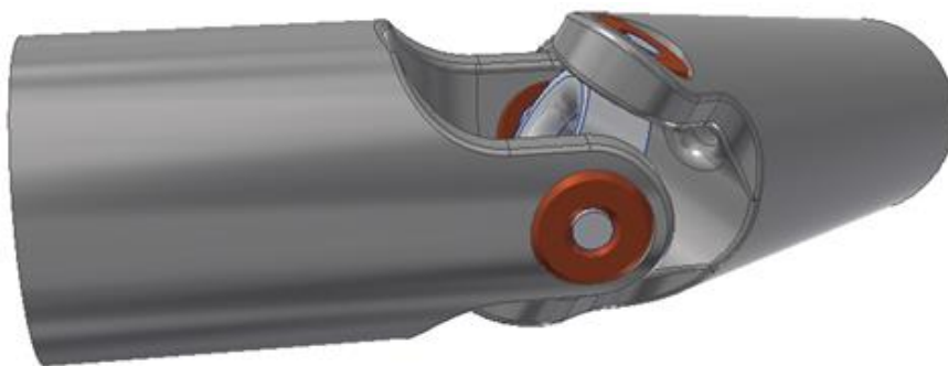
Rys. 1. Model przegubu Cardana wykorzystanego w projekcie robota ROCH-3
