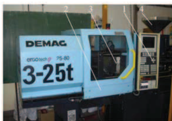
Rys. 1. Wtryskarka Demag Ergotech pro 25-80 użyta w badaniach: 1 – panel sterujący, 2 – osłona układu narzędziowego, 3 – forma wtryskowa, 4 – zasobnik tworzywa
