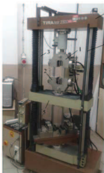
Rys. 2. Maszyna wytrzymałościowa Tira test 2300: 1 – górny uchwyt szczękowy, 2 – dolny uchwyt szczękowy, 3 – kolumny prowadzące, 4 – stół ruchomy, 5 – stół nieruchomy
