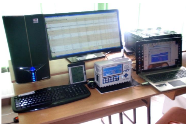
Rys. 1. Miejsce lokalizacji części wewnętrznej stanowiska laboratoryjnego – aparatury pomiarowej (w tym odbiornika sygnałów mikrofalowych)
