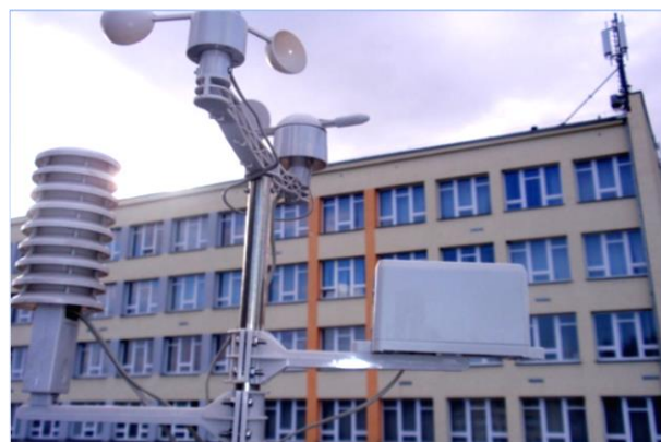
Rys. 2. Zewnętrzna część stacji meteorologicznej
