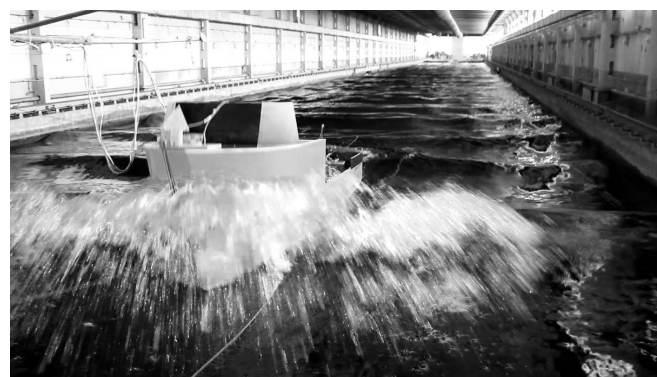
Rys. 2. Fotografia modelowych prób właściwości morskich w głębokowodnym basenie holowniczym dla fali nieregularnej
