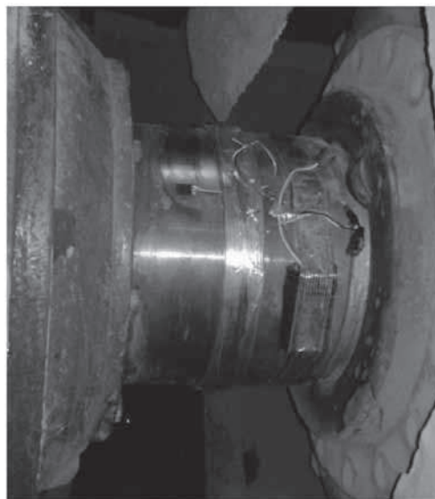
Rys. 5. Układ tensometryczny zamontowany na wale badanego silnika Fig. 5. Strain gauge mounted on the shaft of the tested motor
