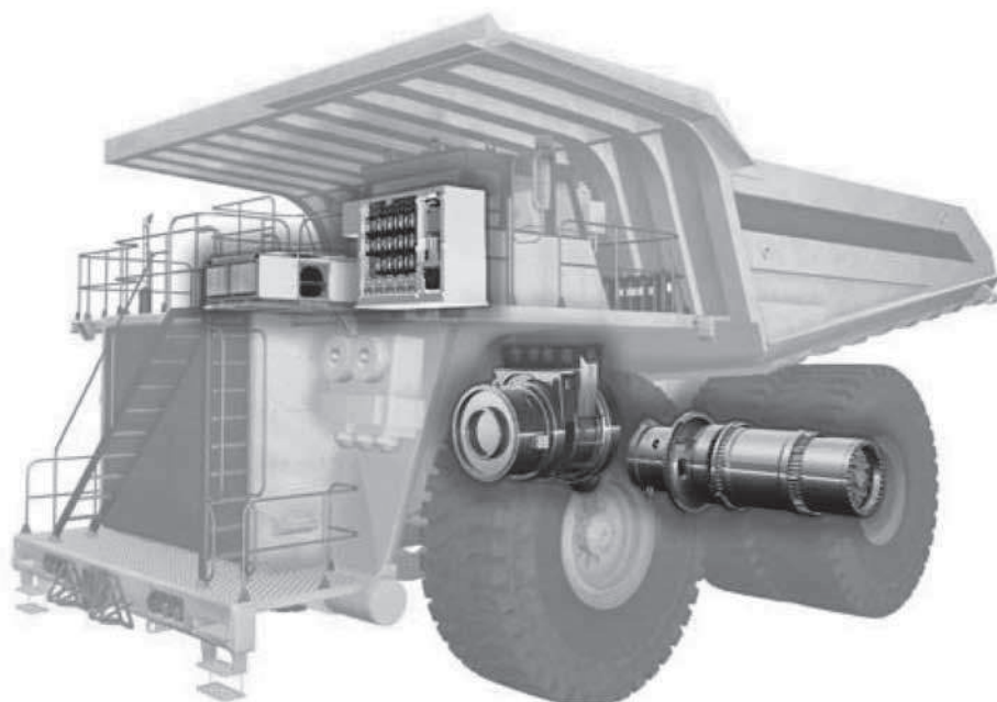
Rys. 2. Wozidło sztywnoramowe wyposażone w napęd spalinowo-elektryczny [9]
