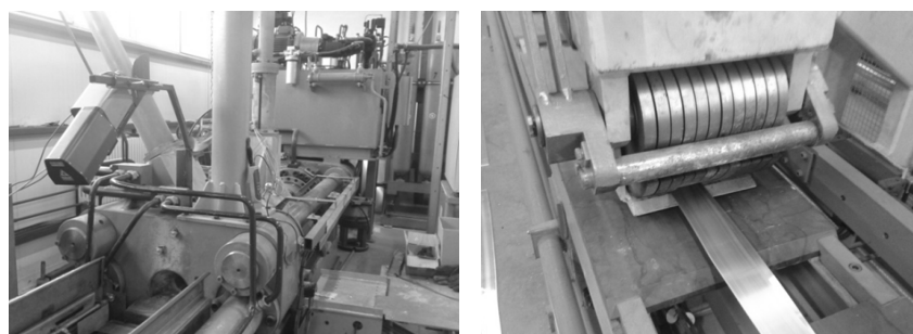
Rys. 6. Prasa hydrauliczna pozioma 5 MN (po lewej) oraz urządzenie ciągnące wyciskany wyrób po wybiegu prasy tzw. „puller” (po prawej)
