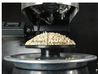
Fig. 4. Reading the angle of repose from A) real measurement, B) DEM simulation Rys. 4. Odczyt kąta spoczynku z A) rzeczywistego pomiaru, B) symulacji DEM
