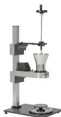
Fig. 2. Device for determining the Powder Flowability PF1 (Sotax) [7] Rys. 2. Urządzenie do określania płynności proszku PF1 (Sotax) [7]
