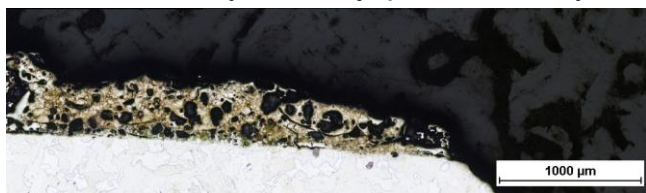
Rys. 4. Mikrostruktura warstwy porowatej wykonanej przy użyciu pasty z oleju silikonowego i proszku Distaloy SE po trawieniu nital-em, powiększenie 50x
