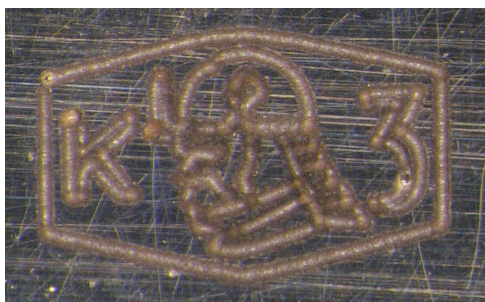
Rys. 10. Zmniejszona cecha probiercza o wizerunku liniowym dla stopów złota próby 0,585 Au
