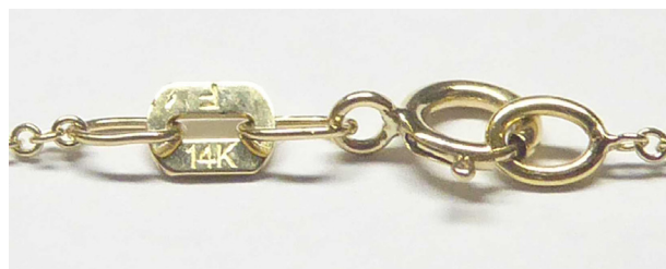
Rys. 3. Zapięcie naszyjnika, w którym oznaczenia producenta zawężają dostęp do powierzchni
