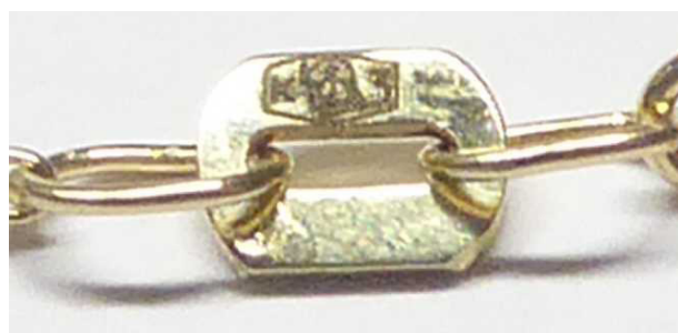
Rys. 13. Zmniejszona cecha probiercza na niewielkiej plakietce naszyjnika
