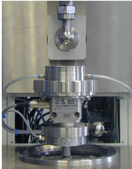
Rys. 24. Układ sił i kierunki obrotów w symulatorze do badania materiałów na endoprotezy (a), tribotester produkcji Instytutu Technologii Eksploatacji – PIB T-24 (b)
