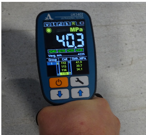
Rys. 3. Ultradźwiękowy pomiar wytrzymałości betonu posadzki Fig. 3. Ultrasonic measurement of floor concrete strength.
