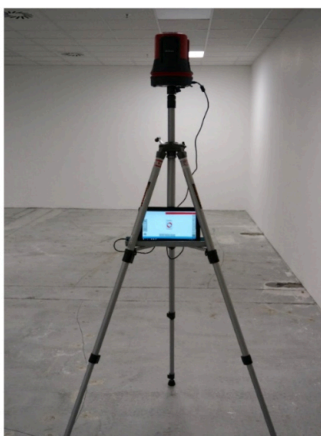
Rys. 9. Badania płaskości posadzki skanerem laserowym: a) urządzenie pomiarowe, b) siatka punktów na powierzchni posadzki Fig. 9. Floor flatness tests using a laser scanner: a) measuring device, b) grid of points on the floor surface
