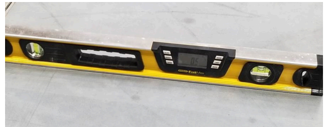
Rys. 7. Niespełnione wymaganie płaskości posadzki Fig. 7. Unfulfilled requirement for floor flatness
