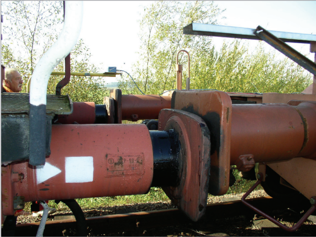
Rys. 6. 80-cio milimetrowa różnica wysokości pomiędzy osiami zderzaków wagonu badanego i otaczającego [fot. A. Zbieć]
