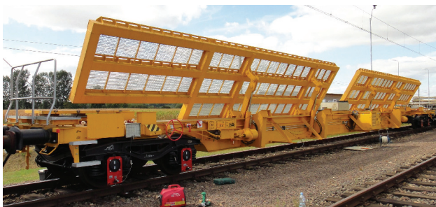
Rys. 23. Długa platforma, o długości 27,5 m na dwóch wózkach, do przewozu rozjazdów [fot. A. Zbieć]
