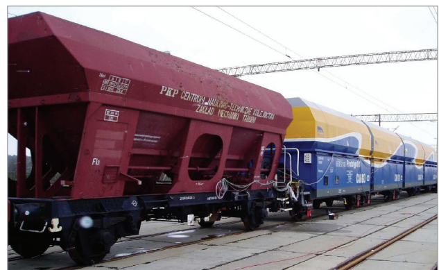
Rys. 19. Czteroczłonowy krótkosprężnięty wagon samowyładowczy o członach dwuosioowych [fot. A. Zbieć]
