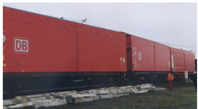
Rys. 20. Wagon dwuosioowy z przesuwными ścianami badany w wariacie uzupełniającym, w którym wagon badany otoczony jest dwoma takimi samymi wagonami [fot. A. Zbieć]
