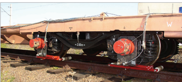
Rys. 7. Głowice do pomiaru sił poprzecznych i urządzenia do pomiaru uniesień kół [fot. A. Zbieć]
