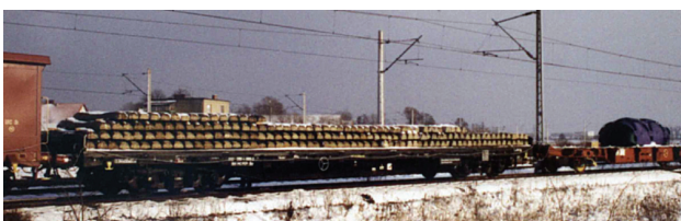
Rys. 16. Platforma dwuosiowa o długości 17,4 m i bardzo dużym zwisie 3,7 m [fot. A. Zbieć]
