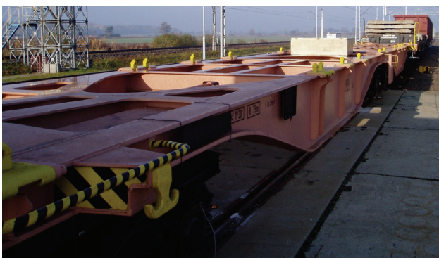
Rys. 22. Platforma dwuczłonowa na trzech wózkach – dwóch wózkach skrajnych i jednym środkowym [fot. A. Zbieć]
