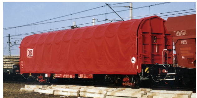
Rys. 18. Wagon wózkowy kryty plandeką [fot. A. Zbieć]
