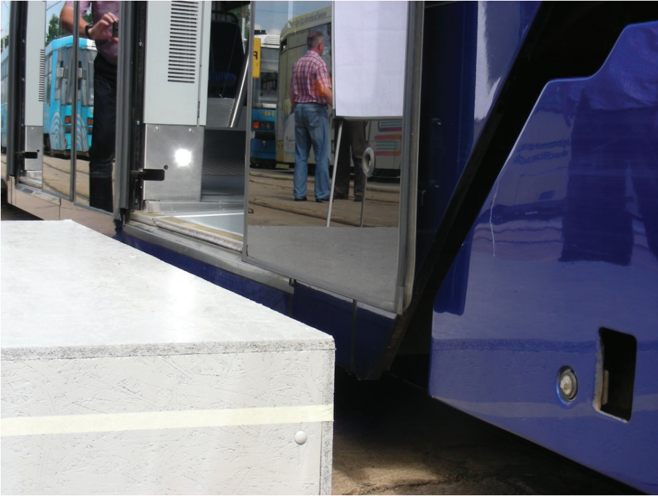
Fot. 2. Prototyp fragmentu krawędzi peronowej podczas badań kompatybilności
