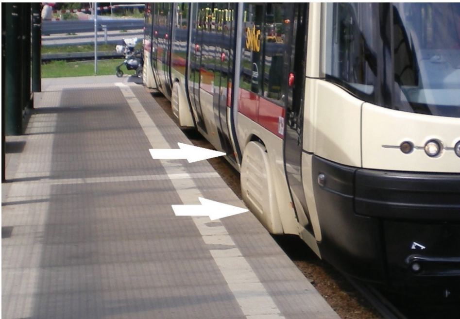
Fot. 1. Tramwaj z osłonami wózków i skosem w dolnej części pudła Na bazie fot. OlsztyńskieTramwaje.pl (fragment)
