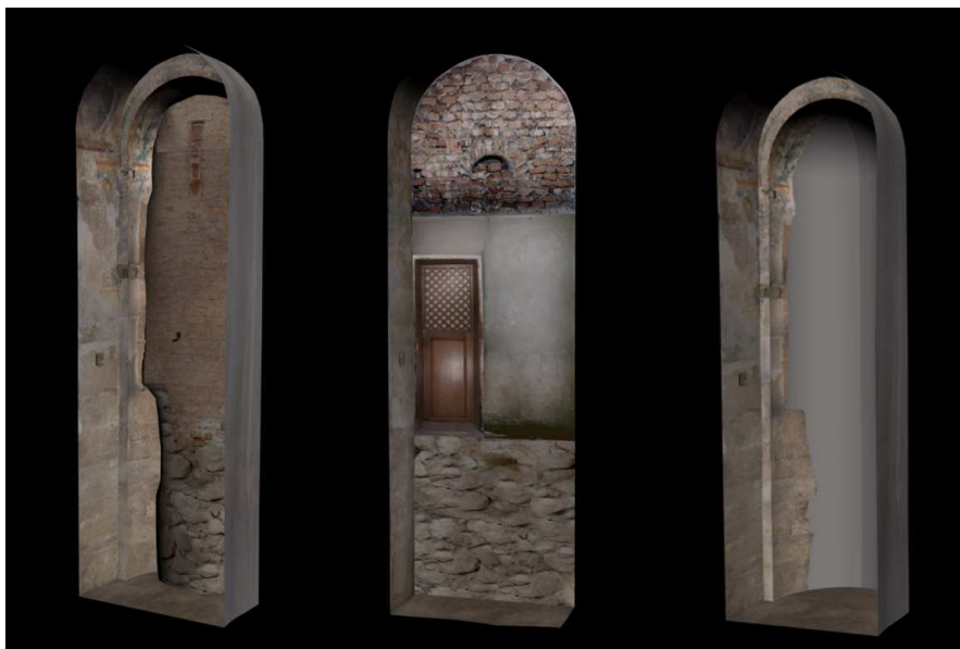
Rys. 7. Wybrane widoki z utworzonych modeli 3D (od lewej: absydiola w stanie aktualnym, ściana wejściowa z nawą, absydiola z odtworzoną powierzchnią konchy)
