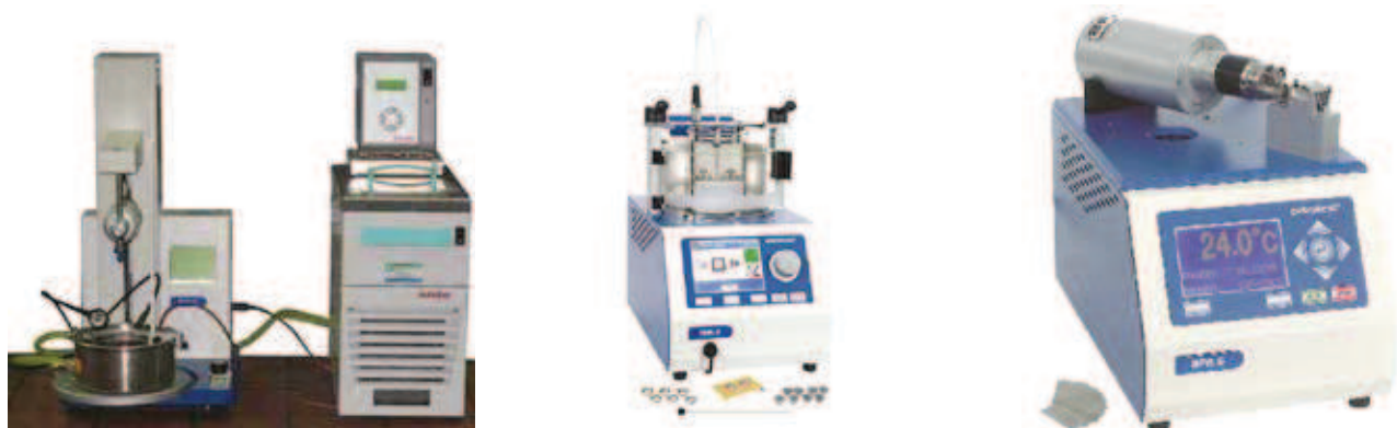
Rys. 4. Aparatura pomiarowa użyta w badaniach: a) aparat do pomiaru penetracji, b) aparat do pomiaru temperatury mięknięcia c) aparat do pomiaru temperatury tlamliwości
