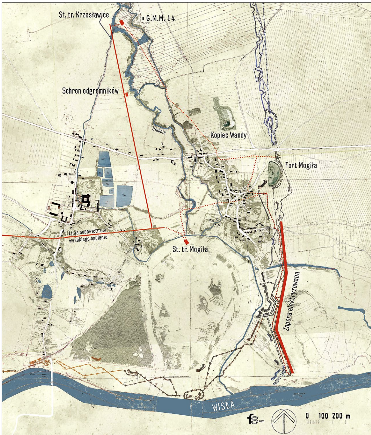
Ryc. 1. Fragment planu fortyfikacji stałych i polowych w rejonie Mogiła, stan z 1915; oznaczono lokalizację schronów stacji transformatorowych, schronu stacji ochrony przeciwprzebieciowej, trasy linii napowietrznych i kablowych oraz przebieg pasa przeszkód; oprac. F. Suchoń.
