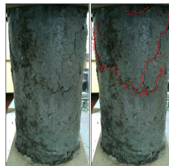
Rys. 1. Zniszczone próbki kompozytu K1 bezpośrednio po badaniach wytrzymałościowych [20].
