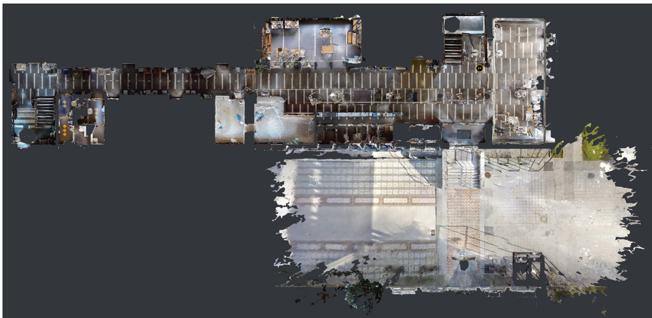
Fot. 1. Wynik skanowania 3D fragmentu parteru Wydziału Architektury w Gliwicach z użyciem połączenia urządzeń Leica BLK360 (na zewnątrz) i Matterport (wewnątrz), (arch. aut.)
