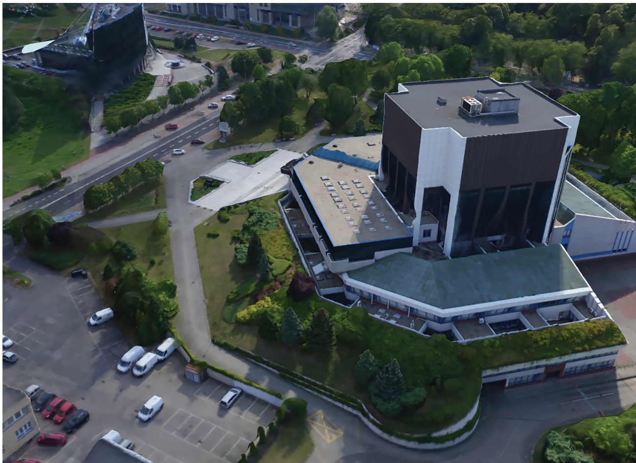
Fot. 2. Render wykonany na bazie modelu 3D stworzonego ze zdjęć z drona DJI Inspire (arch. CyberDron.pl)
