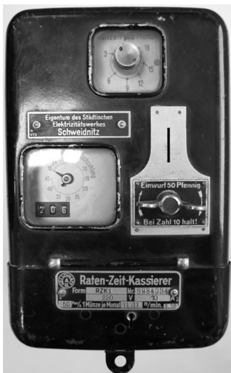
Rys. 1. Wygląd zewnętrzny licznika RZK1 [5]
