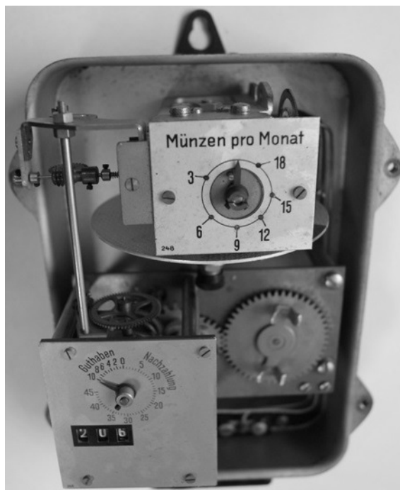
Rys. 2. Wnętrze licznika RZK1, widok od przodu [5]
