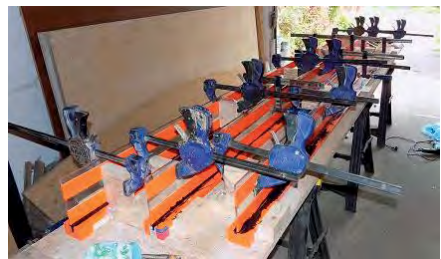
Rys. 7. Widok stanowiska montażowego podczas łączenia belek
