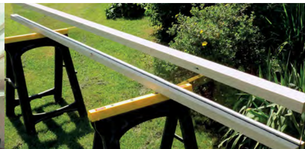
Rys. 1. Belki drewniano-szklane (po lewej) [1], sklejana belka drewniano-szklana do badań własnych (opracowanie własne)
