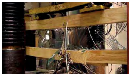
Rys. 5. Obraz wyczerpania nośności zespolonej belki drewniano-szklanej przez rozerwanie pasa drewnianego [13], [15], [16]
