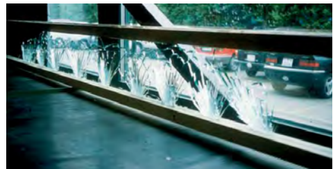
Rys. 4. Ugięcie w zależności od siły belek zespolonych dwuteowych drewniano-szklanych (po lewej), widok zniszczonej belki (po prawej) [6]
