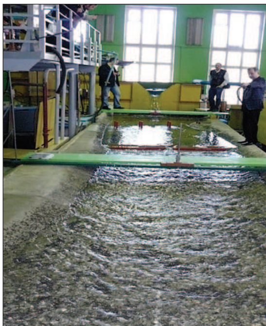
Fot. 4. Hydrauliczne badania zmian dennych (донних перепадів) do ustabilizowania kanału Dniestru w Starym Samborze we Lwowskim obwodzie (Львівська область)
