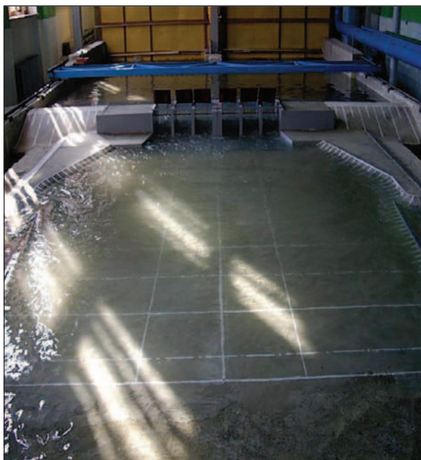
Fot. 2. Wloty hydrauliczne badawczego i gromadzonego zbiornika na r. Tysy w pobliżu wsi Wary i Czertfawla w regionie Zakarpacim (symulacja przejściu katastrofalnej powodzi)
