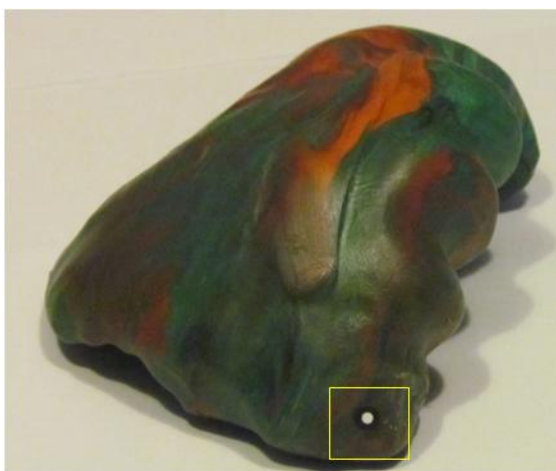
Rys. 7. Model fizyczny gałki zmiany biegów nr 2, z naniesionym znacznikiem umożliwiającym skanowanie
