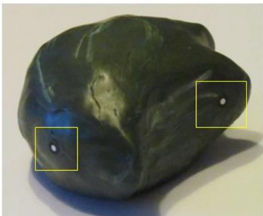
Rys. 6. Model fizyczny gałki zmiany biegów nr 1, z naniesionym znacznikiem umożliwiającym skanowanie
