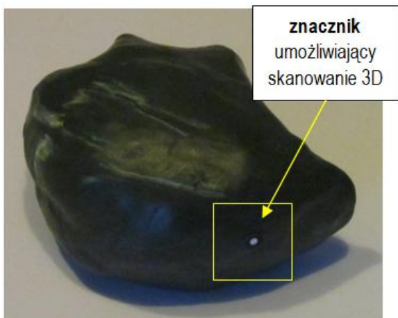
Rys. 5. Model fizyczny gałki zmiany biegów nr 1, z naniesionym znacznikiem umożliwiającym skanowanie
