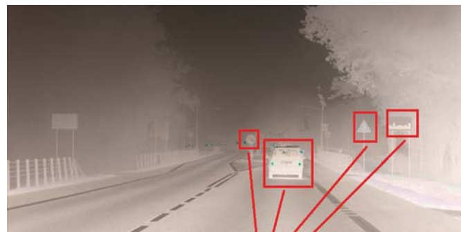
Rys. 2. Rozpoznawanie obiektów na drodze za pomocą lidaru Źródło: oprac. własne.
