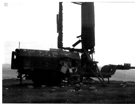
Rys. 2. Skutki ostrzału stacji radarowej ST-68UM z wykorzystaniem rakiety ARM (działania wojenne w Gruzji w 2008 r.) [8]
